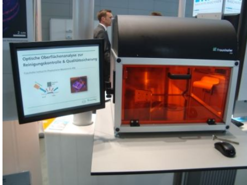
Sistema óptico de control de limpieza
